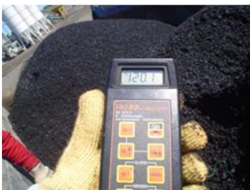
Figura 6: Medición de temperaturas de elaboración y muestreo
