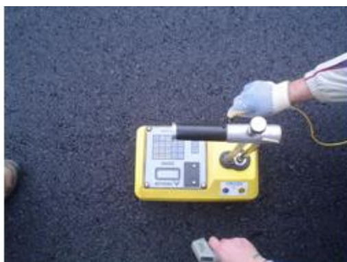
Figura 9: Evaluación de la evolución de compactación con núcleo densímetro
